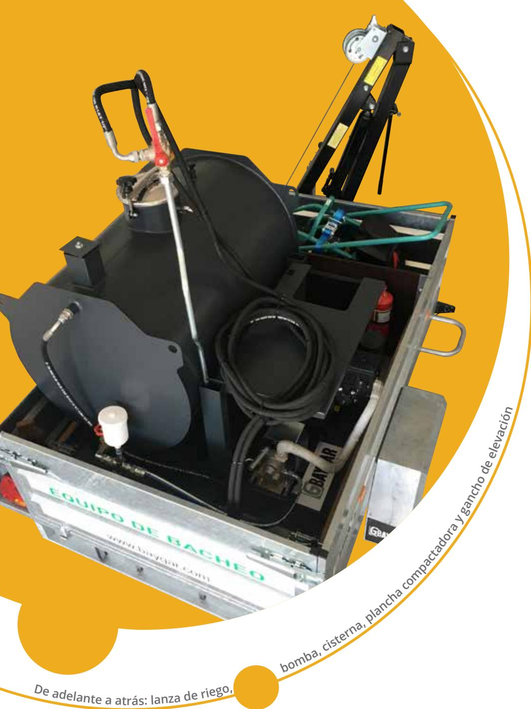
bomba, cisterna, plancha compactadora y gancho de elevación
