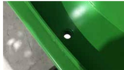
Zona de rotor con perforación de drenaje para evitar la acumulación de agua
