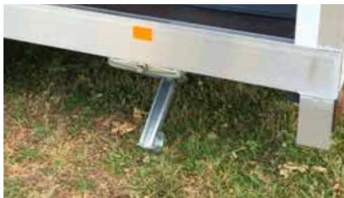
2 patas traseras reforzadas para estabilizar el remolque
