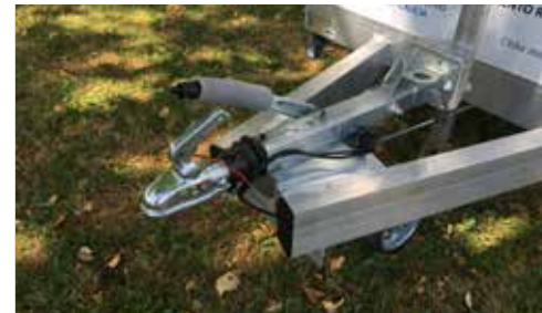
Lanza del remolque de tubo estructural en aluminio
