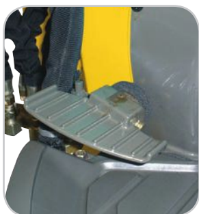
Pedales retráctiles (pedal de toma de fuerza y pedal de orientación de la pluma)
