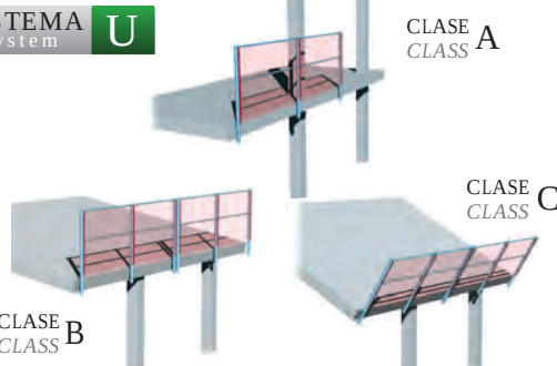
Red de seguridad para protección lateral, barandillas o andamios. Safety nets for edge protection attached to brackets.
