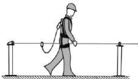
Línea de anclaje flexible horizontal.
