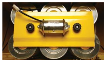
Equipada con 6 filtros cartuchos de alta eficiencia
