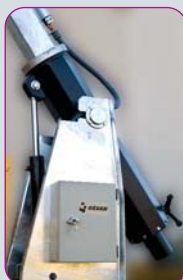
Cuadro eléctrico de elevación (versión hidráulica)
