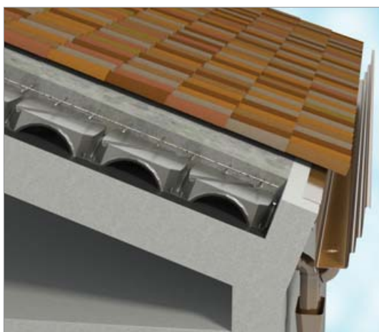
Sección de un tejado inclinado ventilado con Iglu® ventilated roof
