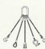
MODELO 8. Terminales varios, para pulpos de 1-2-3 y 4 ramales indistintamente
