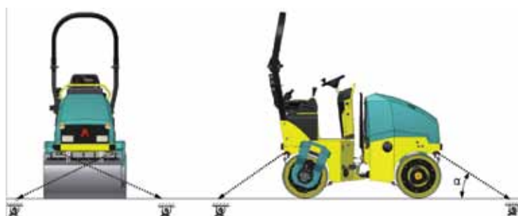
4 cuatro puntos de remolque de sujeción para transporte
