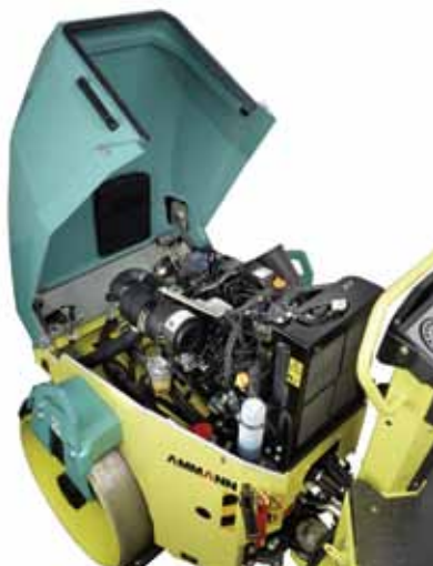
Capota amplia que permite acceso total al motor
