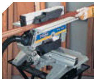
Las versiones TM incorporan una mesa superior para trabajos auxiliares.
