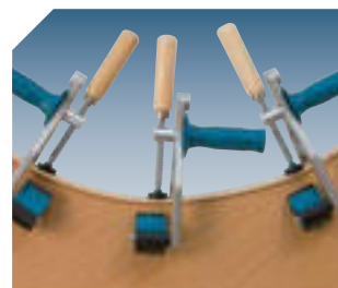
Sujeción de cantos en tableros cóncavos
