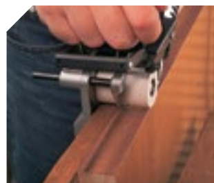
Aplacado de la cara superior del solape.
