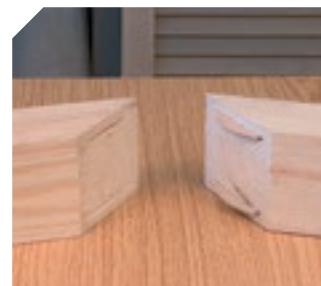
Ensamblajes de extrema solidez con pastillas grandes del No. 6.
