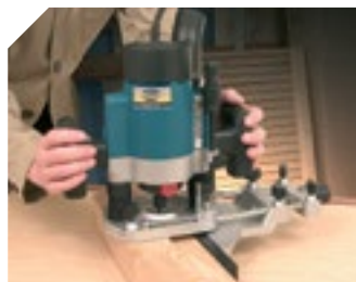
Gran precisión y estabilidad durante el fresado.
