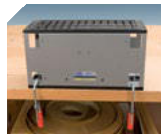
Sujeción sencilla con sargentos sobre superficies rugosas.
