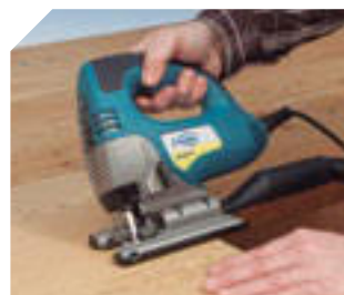
Base inclinable de 0° a 45°.
