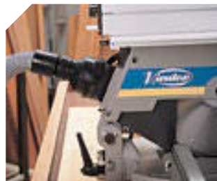
La máquina puede ser conectada a un aspirador.
