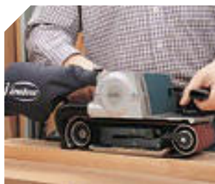
Mod. LB31EA con aspirador del polvo incorporado.
