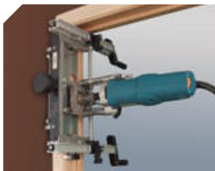
Realización del encaje superior en el marco.
