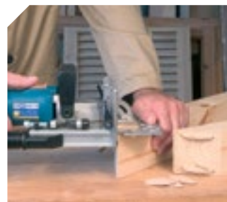
Ensamblajes de extrema solidez con pastillas grandes del No. 6.
