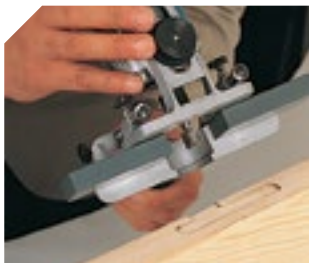
Colocación de pernios con el cabezal ZB93.
