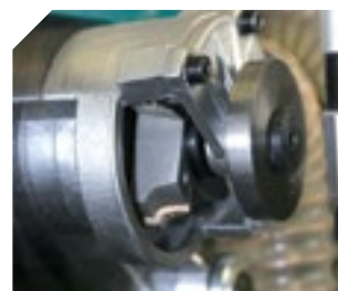
Copiador independiente de la fresa lo cual evita el marcado accidental del panel a perfilar.
