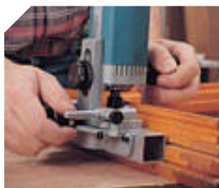
Ranurado de ventana por lado vierte aguas.
