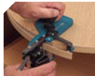
Retestado del sobrante en paneles circulares.
