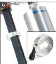
Aro tope para medir la profundidad de perforación.
