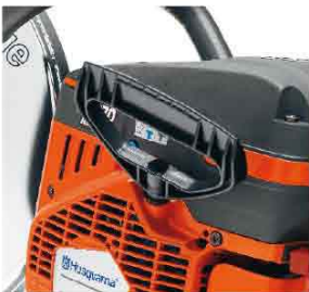
Palanca de arranque de diseño especial, con espacio para guantes de trabajo gruesos.
