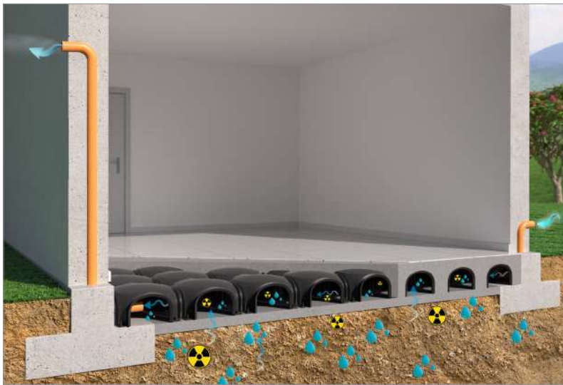
Vivienda construida con unos cimientos ventilados IGLU®.
