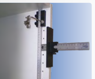
Taladrado para la colocación de bisagras invisibles.
