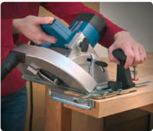
Realizando corte a inglete.
