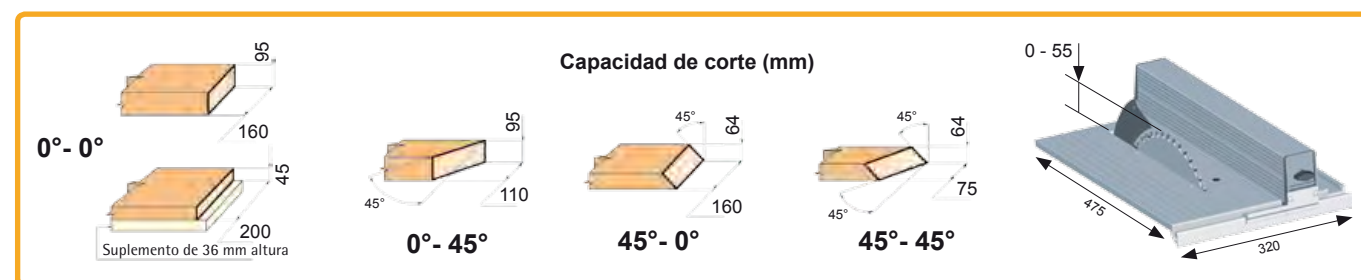
5800100 Mesa de trabajo MT58K. Altura regulable hasta en 4 alturas diferentes y plegable. El transporte de la MT58K puede efectuarse con la máquina fijada.
