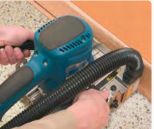
Corte de zócalos o rodapiés.
