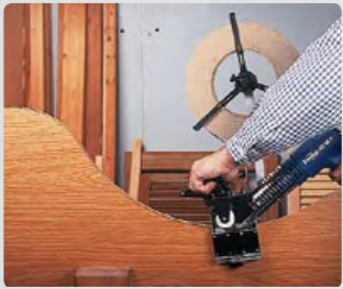
Aplacado de piezas circulares o con formas.
