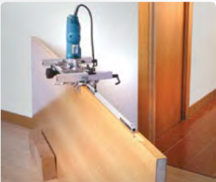
Para la realización de los demás encajes, tanto en el marco como en la puerta, no es necesario ajustar de nuevo la máquina.
