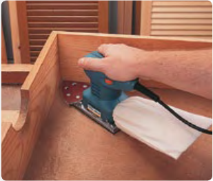
Con la base delta, lijar en esquinas interiores resulta fácil y cómodo.
