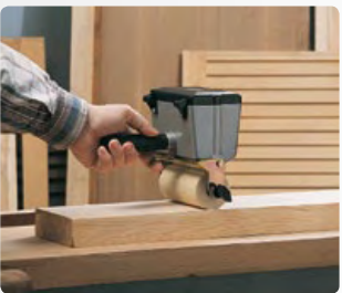
Encolado con colas vinílicas (blancas).
