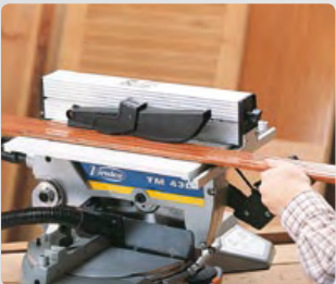
Mesa superior amplia y práctica. Ideal para trabajos auxiliares. Regulable de 0 a 40 mm.
