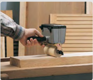
Encolado con colas vinílicas (blancas).
