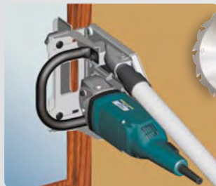
Recorte del marco de madera de la ventana. Registro sobre la escuadra frontal regulable.
