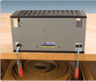
Sujeción de piezas pequeñas sobre una porción dividida del plato de succión.
