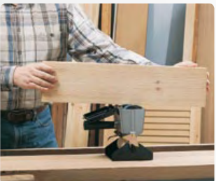
Encolado con el rodillo superior.
