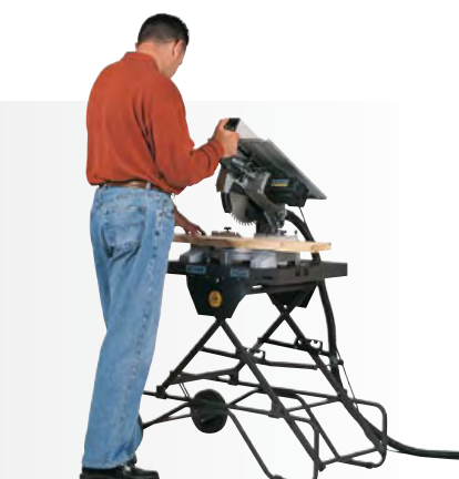
5800100 Mesa de trabajo MT58K. Altura regulable hasta en 4 alturas diferentes y plegable. El transporte de la MT58K puede efectuarse con la máquina fijada.
