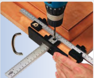
Taladrado para tiradores de puertas.
