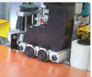
Perfilado simultáneo del canto sobrante por ambas caras, en radio o chaflán a 10°. Rascadores planos a la salida del perfilado.
