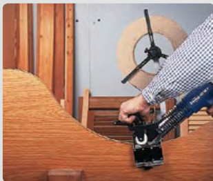
Aplacado de piezas circulares o con formas.
