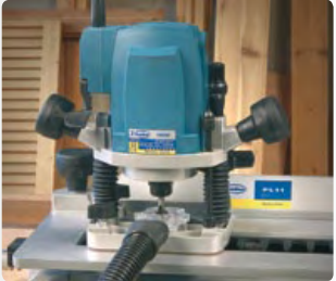
Sistema de bloqueo total de la profundidad de fresado, ideal para la realización de ensamblajes mediante lazos u otros procesos que requieran un total bloqueo del cabezal.
