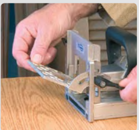
Frontal regulable en ángulo y altura con escalas graduadas.
