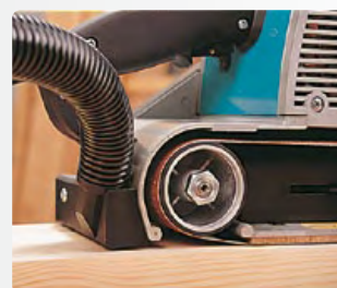
Equipado con toma para aspiración externa.
