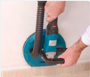
Permite la extracción del frontal para el lijado de esquinas o superficies de difícil acceso.
