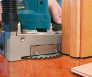
Recorta marcos, sin desmontar los tapajuntas, asegurando un corte impecable y preciso.
