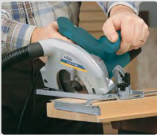
Realizando corte a inglete.
