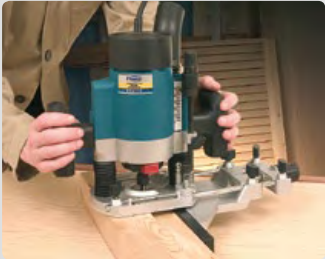
Gran precisión y estabilidad durante el fresado.
