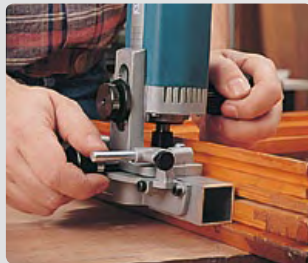
Ranurado de ventana por lado vierte aguas.
