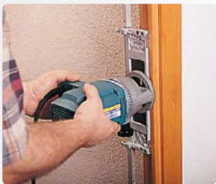
Cabezal CPN66 para la colocación de pernios con plantilla (opcional).
