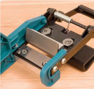
Sistema de corte con dos cuchillas.
