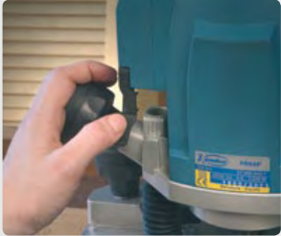
Interruptor de puesta en marcha y bloqueo del cabezal accionables desde la empuñadura, gracias a lo cual se consigue un total y seguro control de la máquina.
