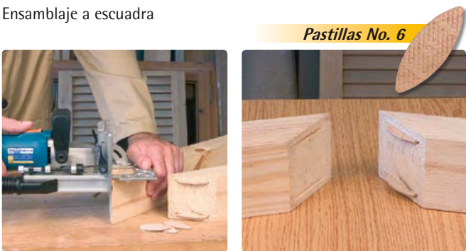
Ensamblajes de extrema solidez con pastillas grandes del No. 6.
