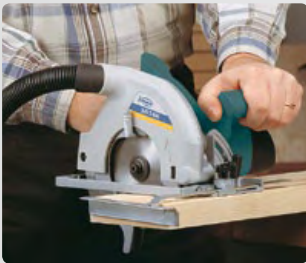
Permite realizar cortes de hasta 51 mm.
