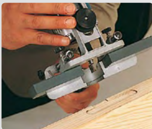
Colocación de pernios con el cabezal ZB93.
