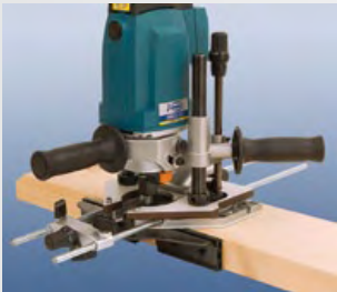
Gran superficie de apoyo en la base, para perfilar o fresar sobre el canto.
