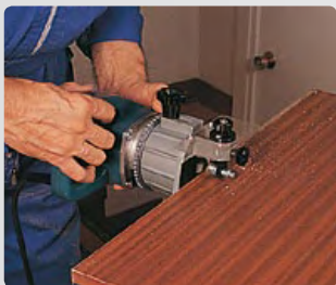
Perfilado de estratificados.
