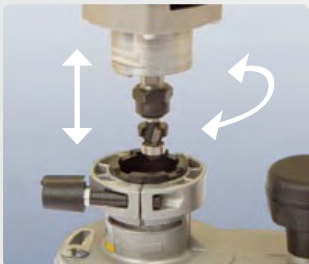
Regulación muy sencilla de la altura de los cabezales con el nuevo sistema de ajuste fino.
