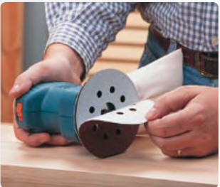
Orificios de aspiración diseñados para permitir la utilización de abrasivos estándar con velcro.
