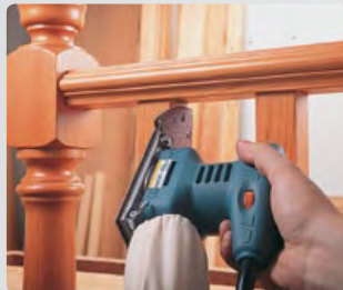
Utilizando la base con punta en delta, el lijado de difícil acceso resulta fácil y cómodo.
