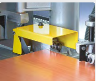
Retestado del canto sobrante anterior y posterior (en cantos de hasta 2 milímetros de espesor).
