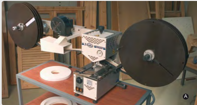
Depósito de cola de fácil acceso. Su sistema de aplicación de cola, incorpora un rodillo de silicona anti-adherente de muy fácil limpieza.
