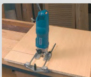
Fresado de regatas paralelas con guía lateral.
