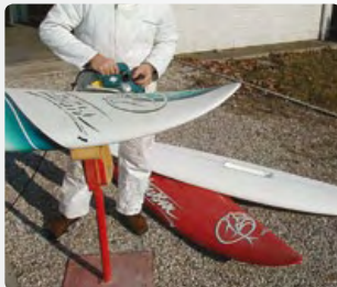
Lijados en piezas compuestas de capas de diferentes materiales con distinta dureza y textura.
