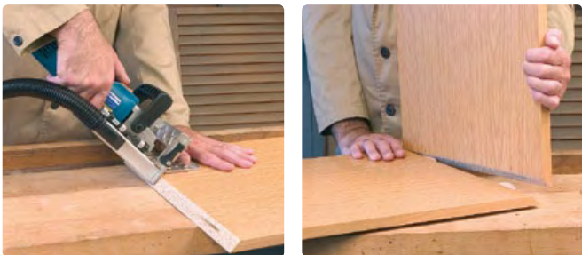
Ensamblaje a inglete
