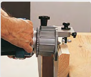
Realización de molduras.
