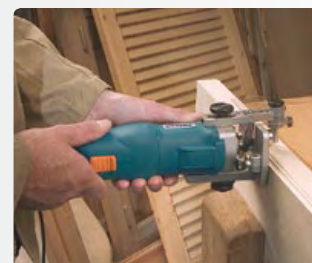
Realización de molduras.
