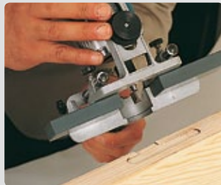
Colocación de pernios con el cabezal ZB93.
