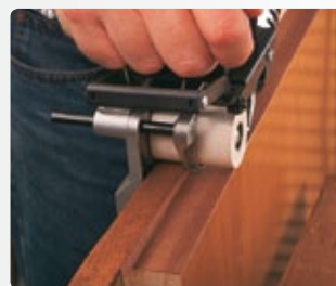
Aplacado de la cara superior del solape.
