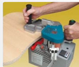
Sujeción sencilla con sargentos sobre superficies rugosas.
