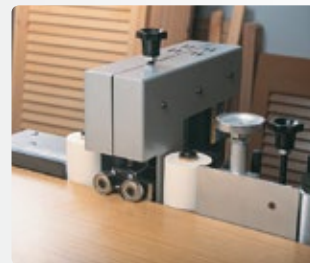
Perfilador motorizado: Perfilado del sobrante por ambas caras simultáneamente.
