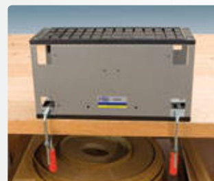
Sujeción sencilla con sargentos sobre superficies rugosas.
