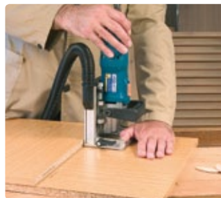
Ensamblaje en medio del tablero
