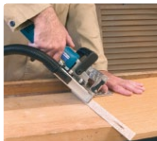
Ensamblaje a inglete
