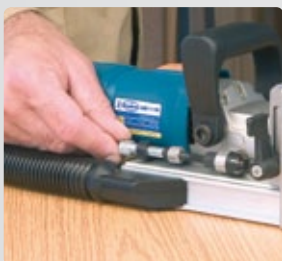
Ajuste rápido para las distintas profundidades de fresado.
