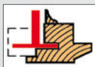
Ranurado de ventana por lado vierte aguas.
