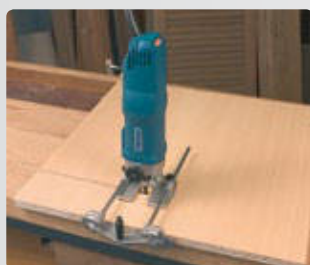
Fresado de regatas paralelas con guía lateral.
