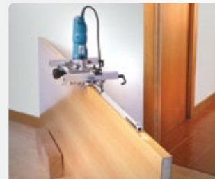
Para la realización de los demás encajes, tanto en el marco como en la puerta, no es necesario ajustar de nuevo la máquina.
