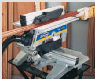
Las versiones TM incorporan una mesa superior para trabajos auxiliares.
