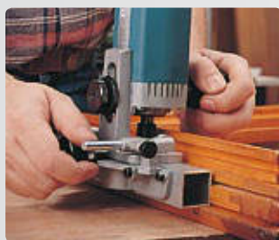
Ranurado de ventana por lado vierte aguas.
