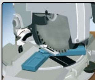
Con la sierra paralela al ángulo indicado por la guía de corte, se consigue un inglete exacto
