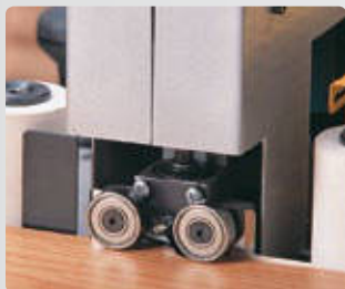
Perfilador motorizado: Perfilado del sobrante por ambas caras simultáneamente.
