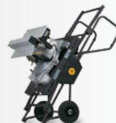
El transporte de la MT58K puede efectuarse con la máquina fijada. También se sostiene en posición vertical, haciendo por tanto más cómodo su traslado.
