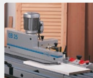
Grupo alimentador: Alimentación de la pieza a cantear.
