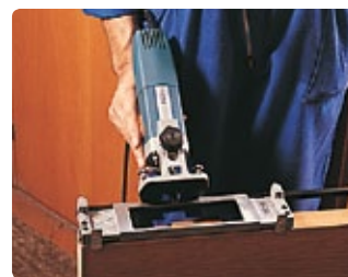
Colocación en la puerta (Mod. A093)
