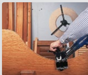
Aplacado de piezas circulares o con formas.
