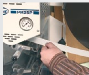
Pre-encolado de tiras sueltas.
