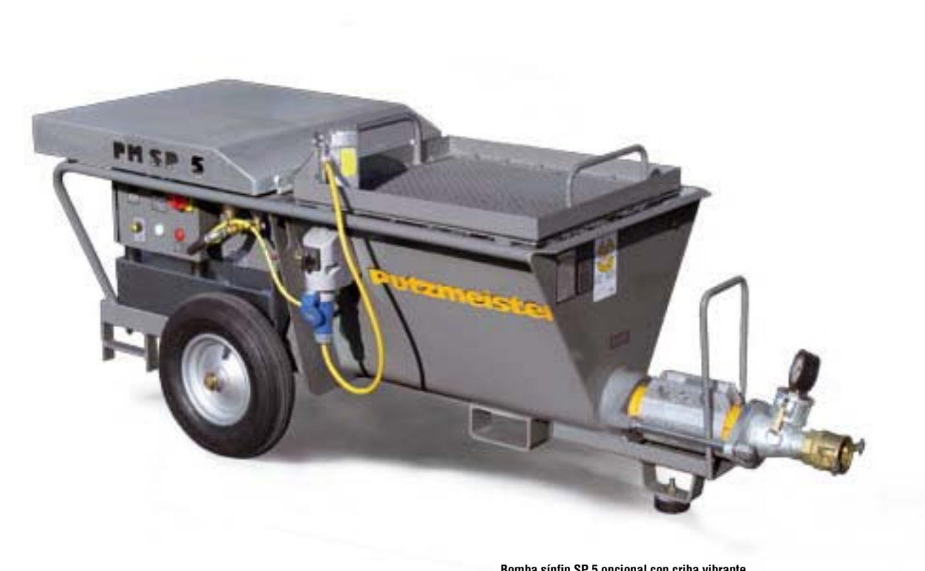
Bomba sínfin SP 5 opcional con criba vibrante
