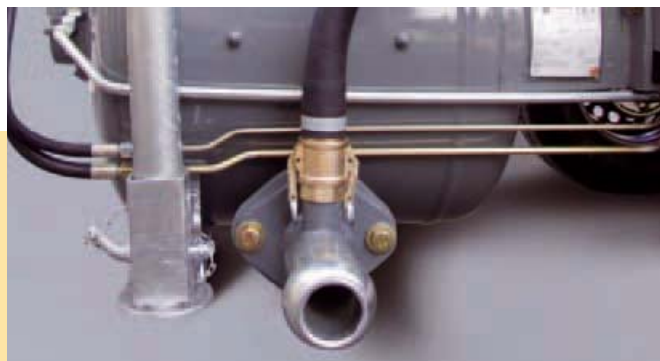
El manguito de presión se puede sustituir en función del diámetro de la manguera de transporte.
