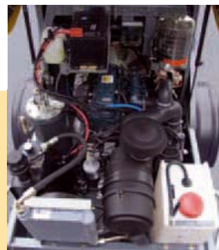
El M 730 dispone de un potente motor diesel de 3 cilindros.
