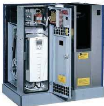
Variador de frecuencia con tarjeta de visualización y programación incluida, montado en la misma máquina.
