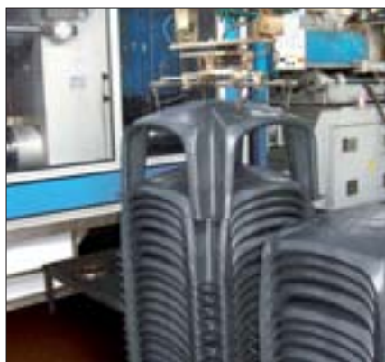
Producción encofrado Guttadrytek®
