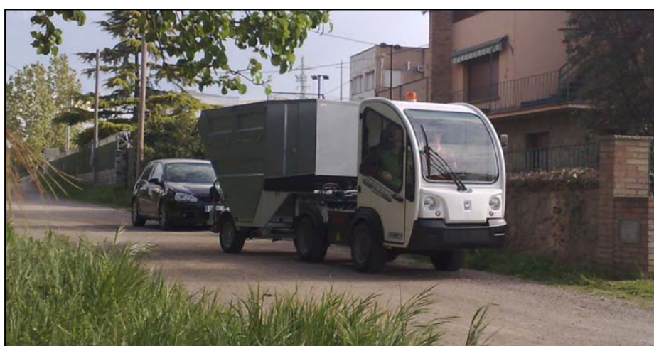
Semiremolque satélite URBACLIC s39 para bolsas de basura
