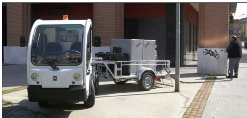
Semiremolque URBACLIC borrador de grafitis SNT
