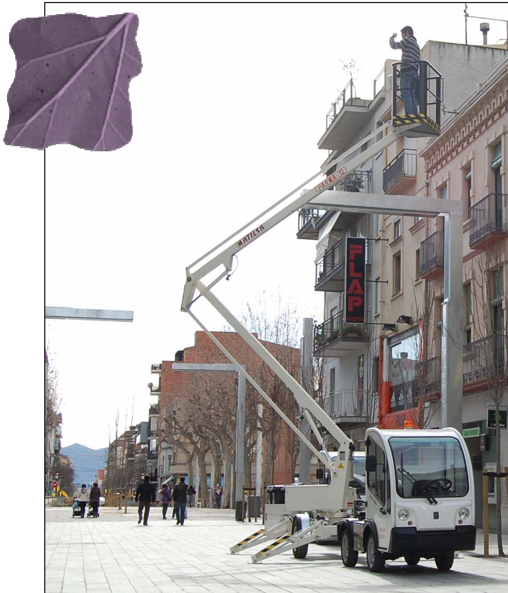
Semiremolque plataforma URBACLIC SMP elevadora de personas
