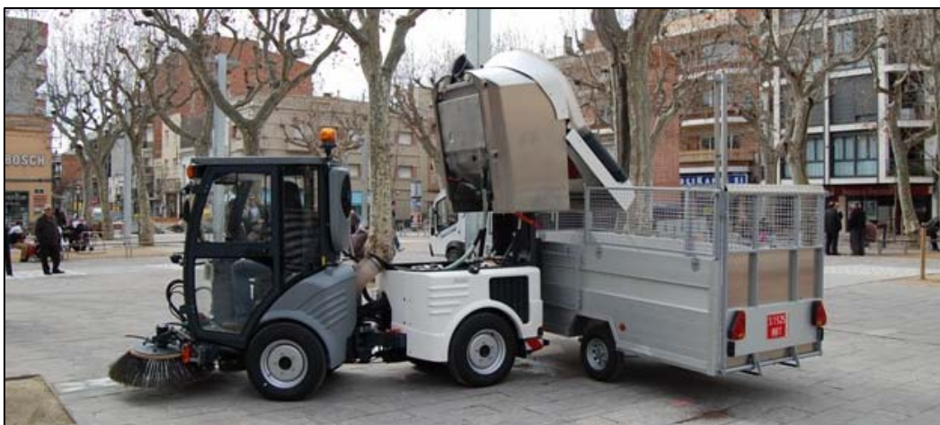
Semiremolque URBACLIC s27 para descarga de barredoras
