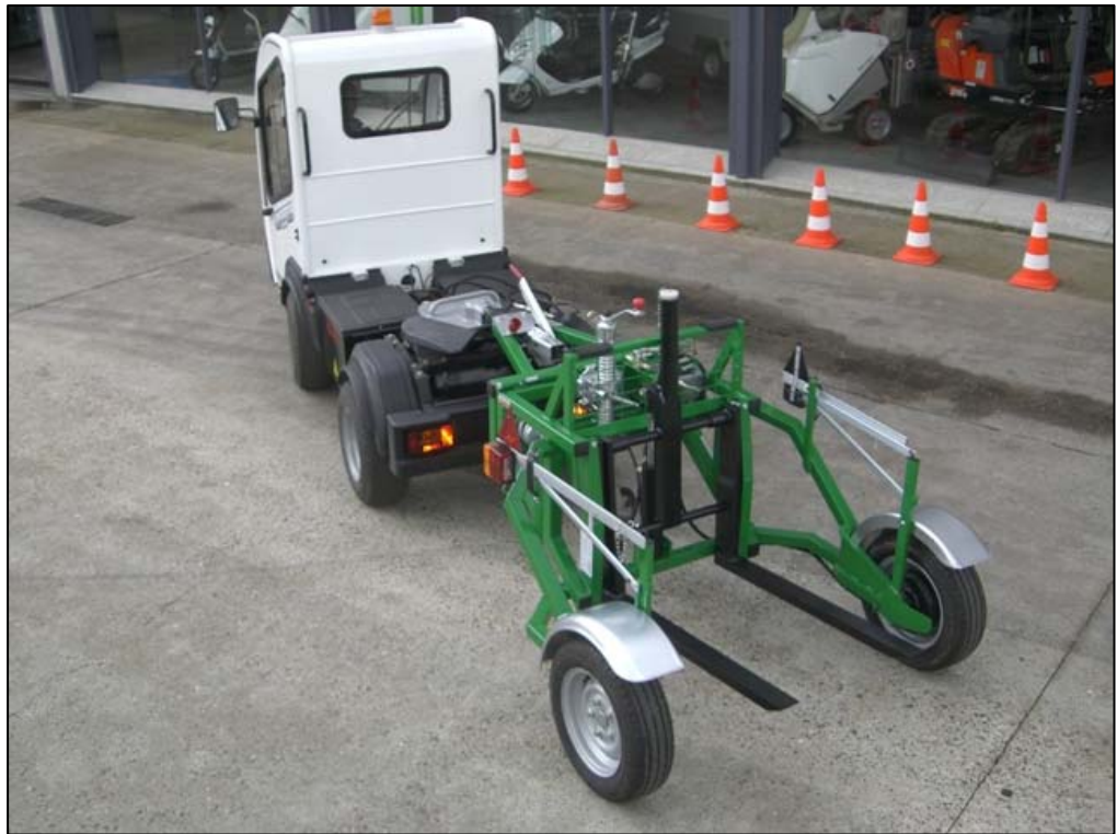
Semiremolque URBACLIC SPL para carga y transporte de todo tipo de palets
