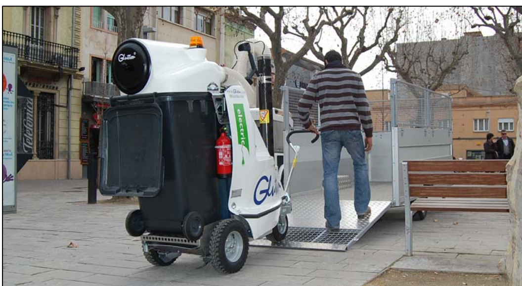
Semiremolque URBACLIC s27 para carga y fácil transporte de maquinaria
