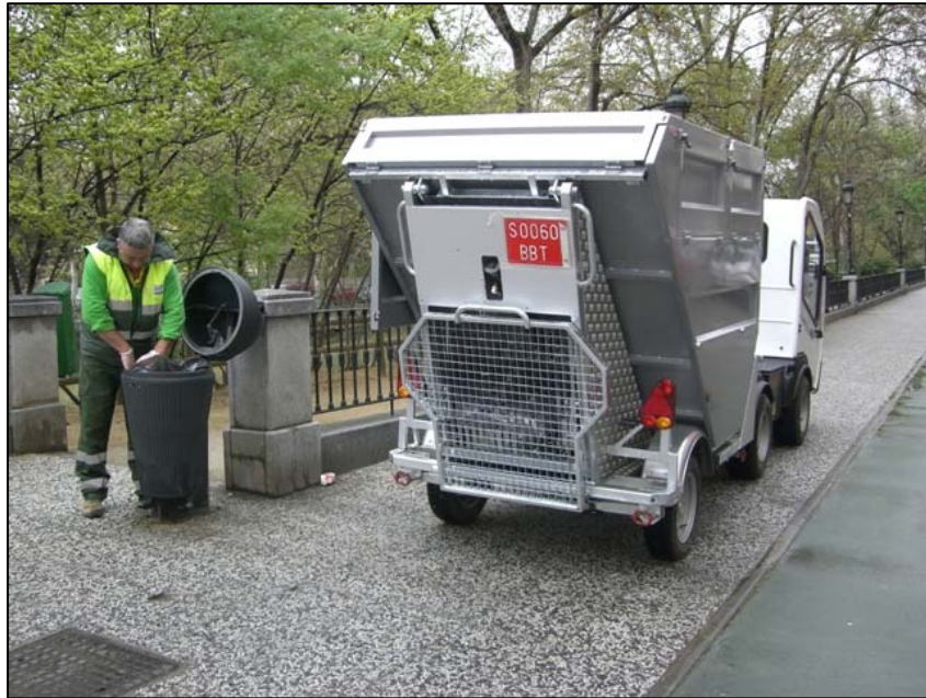
Semiremolque URBACLIC recolector de papeleras S39
