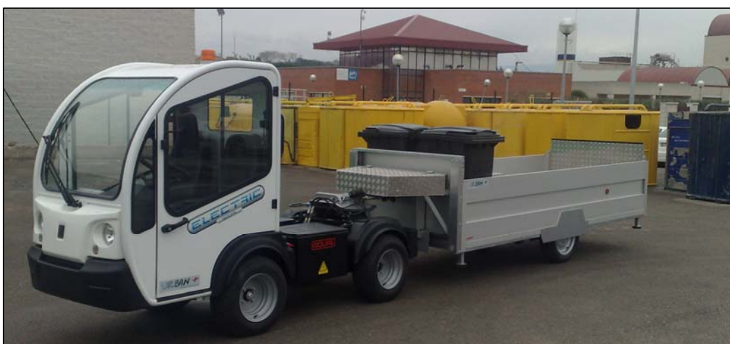
Semiremolque URBACLIC s10 para transporte de contenedores
