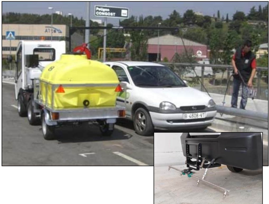
Semiremolque URBACLIC SBR para baldeo a alta presión, baldeo frontal con barra y riego de jardinería
