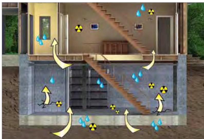
Peligro del gas Radón y de la humedad de remonte dentro de una vivienda construida con cimientos tradicionales.
