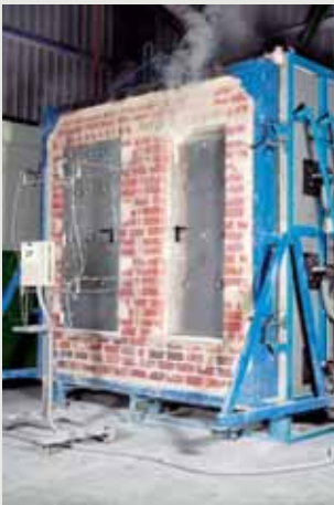
Detalle de 2 puertas Corta-Fuegos, en el horno, durante el ensayo de resistencia al fuego.
