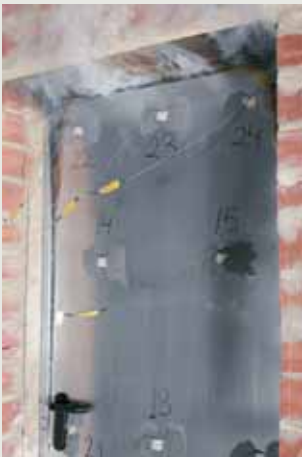
Detalle de los termopares que permiten controlar el aislamiento térmico de las puertas Corta-Fuegos, durante un ensayo de resistencia al fuego.
