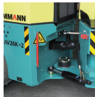
Articulación central lubricada de por vida
