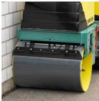
Compactación junto a paredes y esquinas
