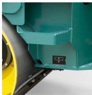
Puntos externos de drenaje
