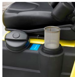
Sistema múltiple de filtración de agua
