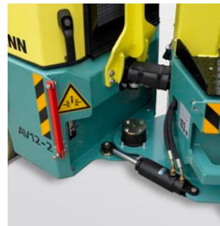
Articulación central lubricada de por vida
