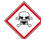
Ref. E04 TÓXICO MUY TÓXICO
