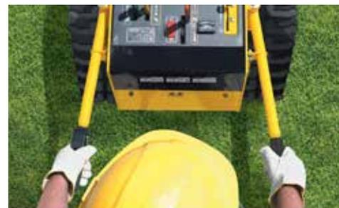
**DIRECCIÓN VZ.** En vez de utilizar palancas adicionales y ruedas orientables, el operador puede girar la máquina solo con los manillares. Además, estos manillares proporcionan fuerza adicional cuando se opera en terrenos difíciles.
