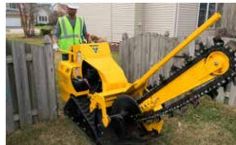
**DISEÑO DE PERFIL DELGADO.** Un ancho de 87,6 cm (34,5") permite que la unidad pase por áreas estrechas y puertas angostas.
