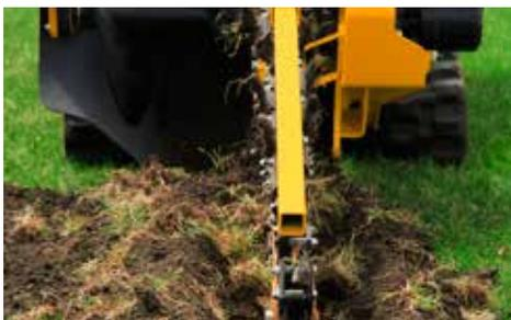
**SOPORTE DE COJINETE EXTERIOR:** Esta función proporciona protección para el eje del cabezal cuando abra zanjas en condiciones difíciles, lo que permite bajar los costos totales de operación.
