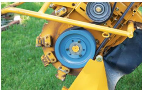
**SISTEMA PATENTADO DE CORTADORES YELLOW JACKET™.** Diseñado para un reemplazo más rápido, así como prolongar la vida útil de los dientes (bits).
