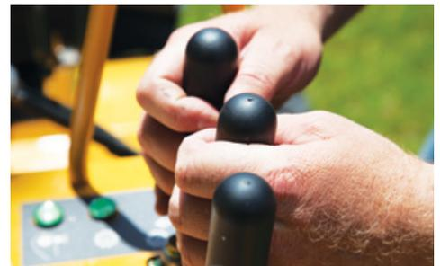
**SISTEMA DE SEGURIDAD PRESENCIAL DEL OPERADOR.** Este sistema tiene el objetivo de proteger al operador. Las perillas de control para el giro, elevación y descenso del disco están equipadas con sensores de presencia.
