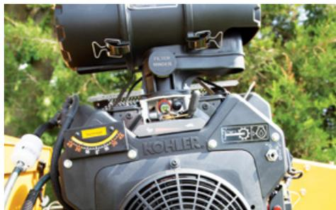
**MOTOR KOHLER 26 HP GASOLINA.** Con inyección electrónica, es más eficiente que los motores carburados del mismo tamaño, aumenta el ahorro de combustible y reduce la emisión de gases de efecto invernadero.
