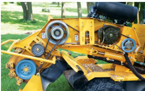
**AJUSTES DE LAS CORREAS.** Las correas de accionamiento del disco se ajustan de manera independiente mediante rodillos-guía, sin afectar el ajuste de las demás. Practicidad durante el mantenimiento.
