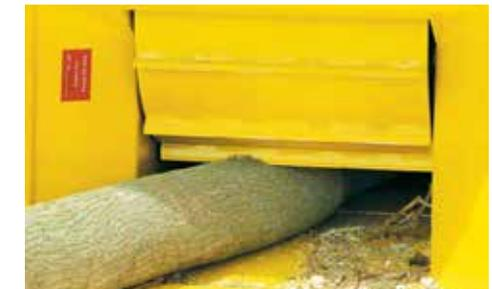
**RODILLO DE ALIMENTACIÓN** Una abertura de alimentación de buzón grande (44 cm x 30 cm [17" x 12"]) permite mejorar la productividad mediante la reducción de la necesidad de recortar el material antes de alimentarlo en la astilladora.
