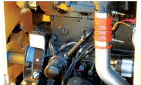
**RENDIMIENTO POTENTE.** El motor Deutz TD2.9L Tier 4 Final brinda 55 kW (74 hp) de potencia para un rendimiento excelente.
