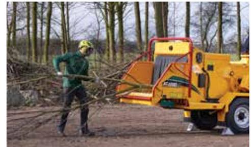
**SISTEMA SMARTFEED PATENTADO.** El sistema SmartFeed patentado permite aumentar la productividad del operador, mientras se reduce la tensión en las piezas fundamentales del motor. El sistema de control de detección de alimentación monitorea las rpm del motor y automáticamente detiene e invierte los rodillos cuando se alimentan materiales de madera más grandes.
