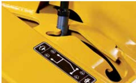
**SISTEMA DE PTO SIN EMBRAGUE.** Un sistema de PTO sin embrague permite que el cortador se active sin utilizar un embrague deslizante tradicional o una polea de guía y sin deslizar el motor. El sistema se mantiene fácilmente; una vez bajo la carcasa, los cambios de correa se realizan fácilmente sin el uso de herramientas.
