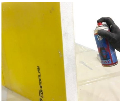
Fig. 30: Fijación provisional mediante adhesivo en spray.
