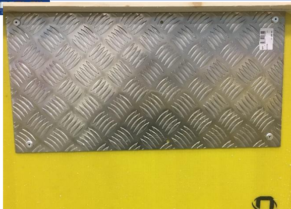
Fig. 11: Elemento fijado al panel mediante remaches tipo flor.
