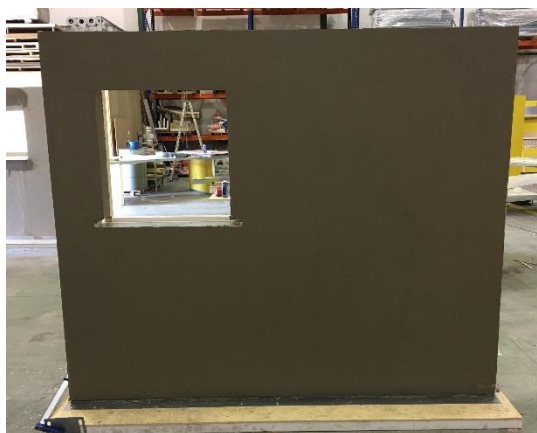
Fig. 13: Revestimiento de mortero flexible a modo de puente de unión.
