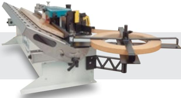
Mesa inclinable MI250. Diseñada para el encolado de paneles con inclinación de 15° a 50°.
