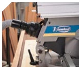
La máquina puede ser conectada a un aspirador.
