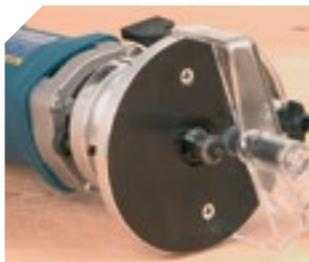
Incorpora un sistema de freno de rodamiento de la fresa, que evita el giro de éste al inicio, de forma que no se produzcan marcas accidentales sobre el panel.
