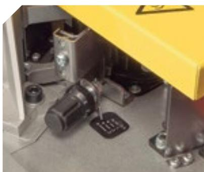
Dispone de un sistema de regulación del espesor del canto muy simple y rápido. Permite el uso de cantos de hasta 3 mm de espesor.
