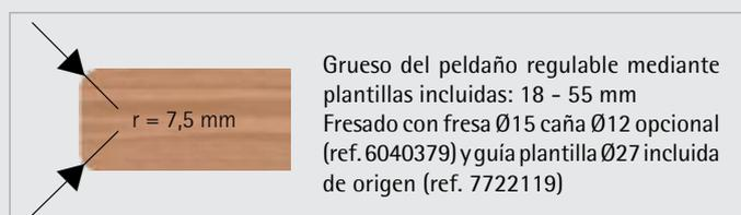
Grueso del peldaño regulable mediante plantillas incluidas: 18 - 55 mm
