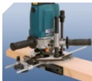
Gran superficie de apoyo en la base, para perfilar o fresar sobre el canto.
