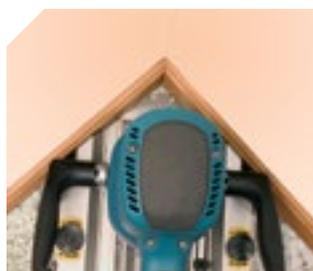
La posibilidad de extraer el frontal de la máquina muy fácilmente, permite mejorar el acceso a las esquinas, en el recorte de zócalos.
