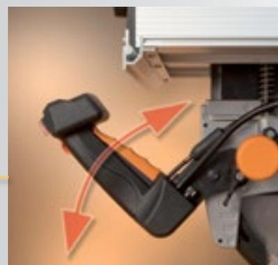
Empuñadura ergonómica y ajustable en altura, lo que permite adaptar su posición a la más adecuada para cada trabajo. Incorpora un sistema de aislamiento estanco que protege el interruptor del polvo resultante de los trabajos de tronzado, evitándose así averías en el futuro.
