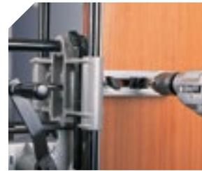
(Incluido en el equipo) usando el útil UT16I se obtiene la referencia para taladrar el alojamiento del bombín y aguja.
