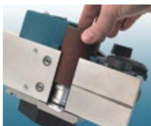
Sustitución de los rodillos lijadores sin herramientas.
