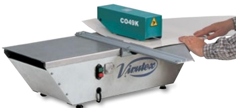
Destaca especialmente la posibilidad de trabajar con láminas de cualquier tamaño, ofreciendo su mesa de trabajo el apoyo suficiente para obtener buenos cortes.
