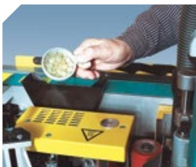
Tolva para una fácil recarga del depósito de cola. Incluye un dosificador que permite añadir cola durante el proceso de aplacado, desde la posición de trabajo, sin detener la máquina.
