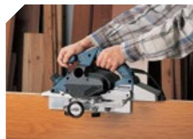
Escuadra micrométrica que permite realizar cepillados inclinados a distintos grados.
