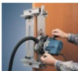
Realización de los orificios laterales para la colocación de la manilla, cilindro u otros mecanismos.
