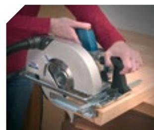
Permite realizar cortes de hasta 70 mm.
