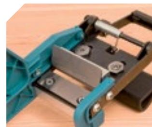
Sistema de corte con dos cuchillas.
