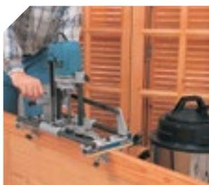
Posibilidad de trabajar en posición horizontal. Muy útil si se desea realizar en serie los cajeados, con las puertas descolgadas.
