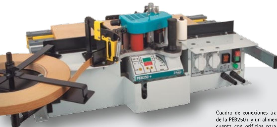
Cuadro de conexiones trasero para la conexión de la PEB250+ y un alimentador auxiliar, la mesa cuenta con orificios para su fijación. (Modelos PEB250TRM y PEB250TA)
