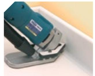
Primer fresado con la fresa de radio 10 mm.
