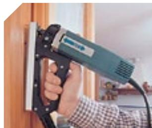
Dispone de un pivote de centrado, que facilita la entrada de la fresa al iniciar el proceso de ranurado.
