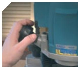
Interruptor de puesta en marcha y bloqueo del cabezal accionables desde la empuñadura, gracias a lo cual se consigue un total y seguro control de la máquina.
