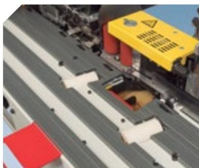
Rodillo de presión motorizado. Depósito de cola de fácil y cómoda recarga. De óptima capacidad y mínimo mantenimiento gracias al recubrimiento de Teflón®.
