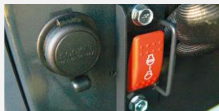
Parada eléctrica del motor (parada de emergencia)
