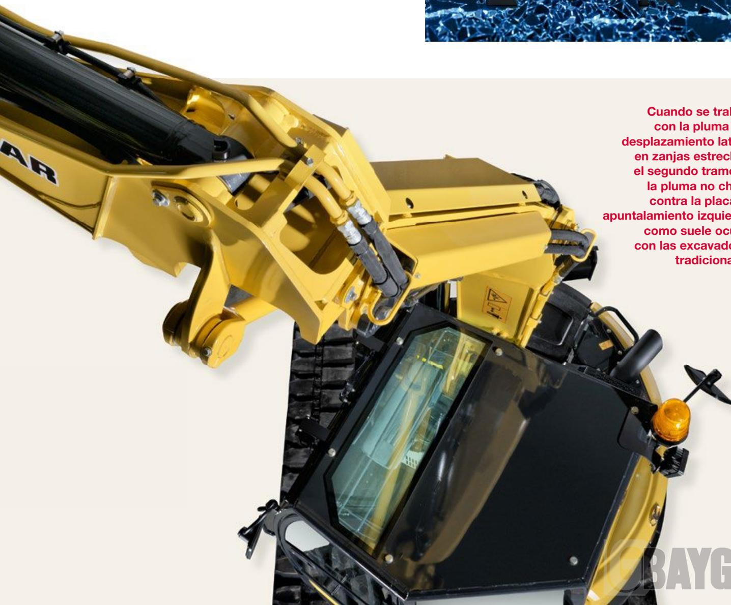
**Quando se trabaja con la pluma con desplazamiento lateral en zanjas estrechas, el segundo tramo de la pluma no choca contra la placa de apuntalamiento izquierda, como suele ocurrir con las excavadoras tradicionales.**
