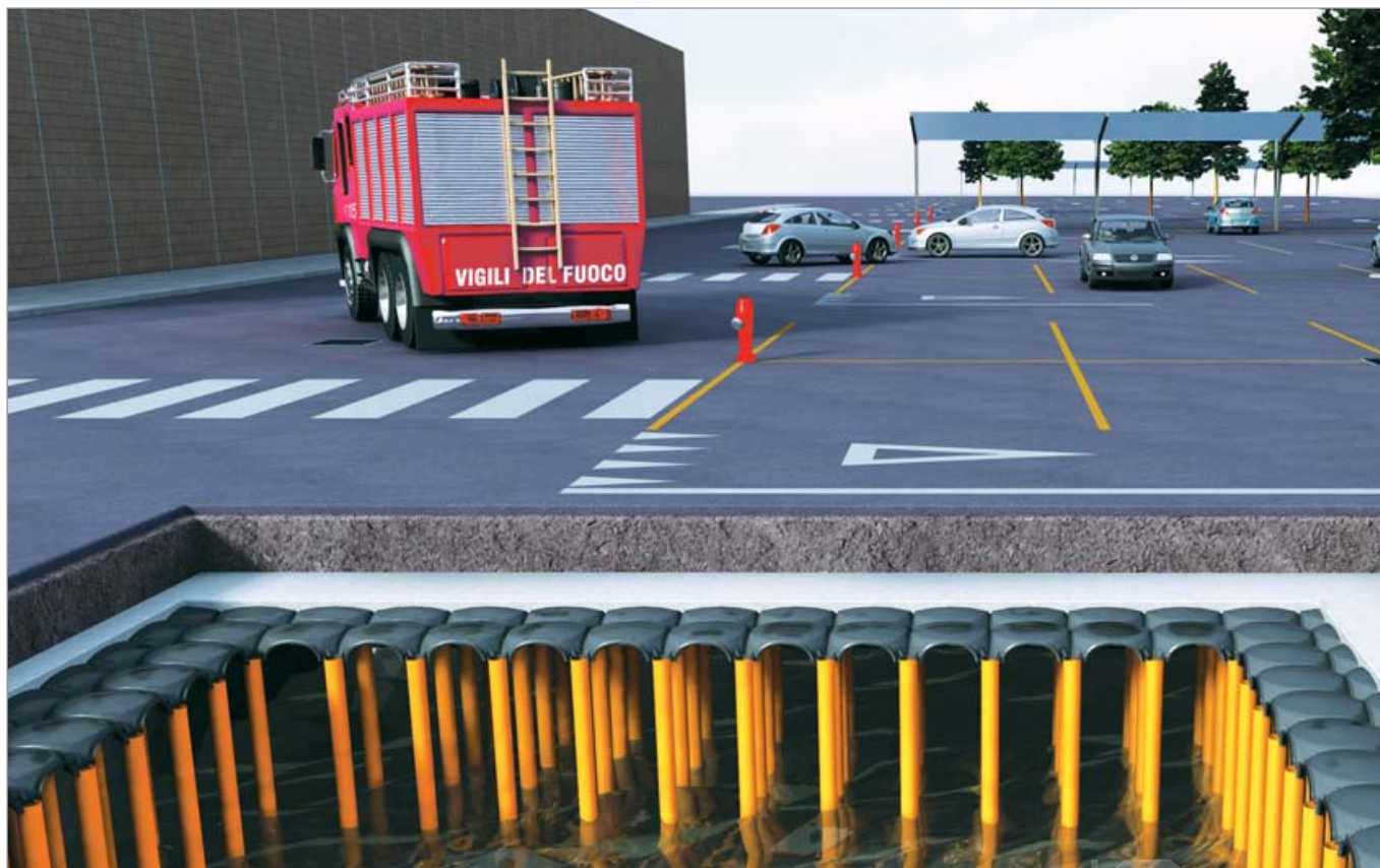
Cisterna de recogida explotable como instalación contra incendios
