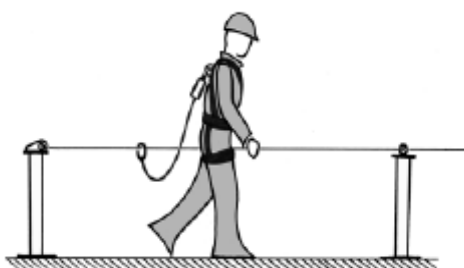
Línea de anclaje flexible horizontal.
