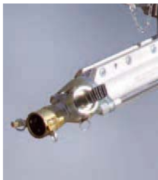
La potente bomba sinfín 2L6 con manguito de presión para la conexión de manguera.
