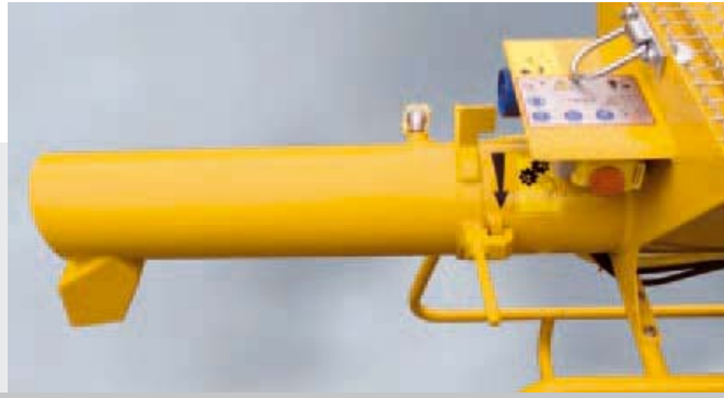
El práctico tensor rápido permite desmontar el tubo de mezclado con gran facilidad.
