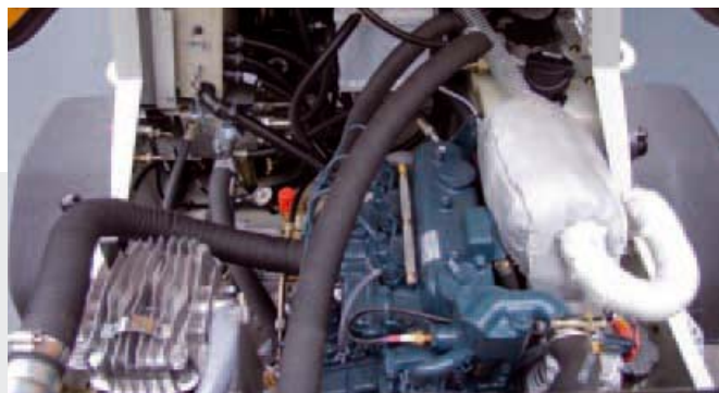
La velocidad de rotación máxima del motor, de sólo 2.600 rpm, y su óptima insonorización hacen de la SP 11 una máquina especialmente silenciosa.
