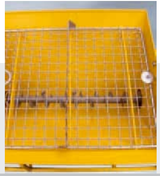
La gran tolva del mezclador continuo facilita enormemente el llenado gracias a su baja posición.
