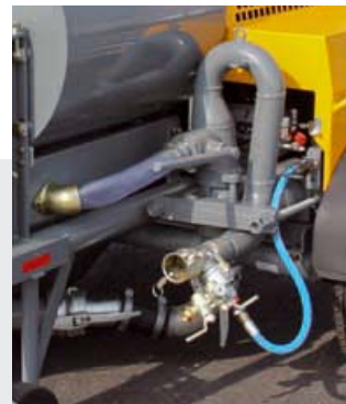
Tubo de presión de la nueva bomba de émbolo KA 230 de la P 13 para conectar la manguera.
