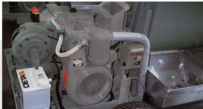
El potente motor diesel bicilíndrico funciona en una franja de revoluciones comparativamente baja, es sumamente robusto y necesita muy poco mantenimiento.
