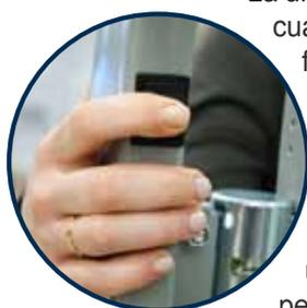
La unidad queda automáticamente frenada cuando está parada ya que la rueda de freno está siempre activada. Cuando el operario necesita mover la unidad, simplemente pulsa un interruptor ubicado en la barra protectora de la plataforma para desbloquear el freno para poder empujar la unidad a un nuevo sitio de trabajo. Un reducido peso total del equipo de tan solo 230 kg permite moverlo con facilidad y confort sobre cualquier tipo de suelo.
