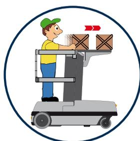
La plataforma de carga a la máxima altura coincide con el mástil. Es muy fácil colocar incluso paquetes pesados usando la columna como base de apoyo haciéndola deslizar a la plataforma.
