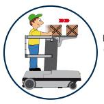
El piso de carga a la altura máxima coincide con la columna. Es un apoyo muy cómodo incluso con bultos pesados, utilizando la columna como base de apoyo.
