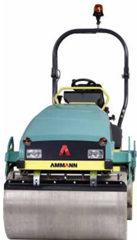
Eje ajustable del tambor de hasta 40 mm
