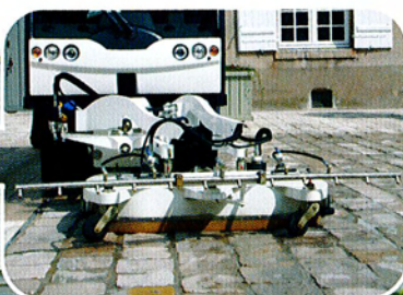
Desviación hidráulica izquierda y derecha de la herramienta de decapado (400 mm)
