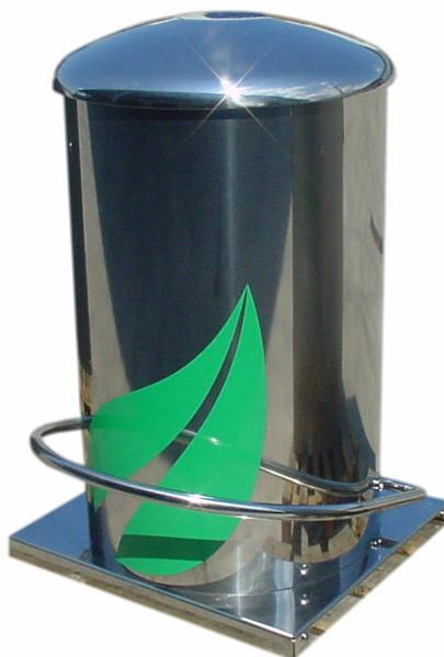
**CUERPO.** Fabricado en Acero inoxidable AISI-304 con acabado brillante o mate. Forma cilíndrica, biselado en la parte superior. Chapa e: 2/3 mm
