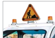
Triángulo de señalización de trabajos con iluminación tipo LED sobre la cabina
