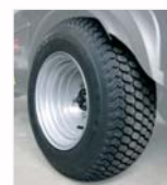
Neumáticos anchos de baja presión (23x8,5x12)
