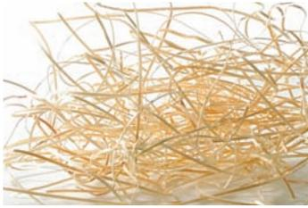
Celenit es un aislante termoacústico **natural**, fabricado a base de fibras de madera de abeto largas y resistentes (65%), unidas a presión con aglomerado de cemento Portland (35%), formando una estructura alveolar ligera, resistente, compacta y de ilimitada durabilidad. El tratamiento mineralizante posterior mantiene inalterables las propiedades mecánicas de la madera, anulando los procesos de deterioro biológico.
